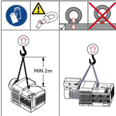
La bomba sólo puede fijarse al cáncamo/orificio de elevación.
