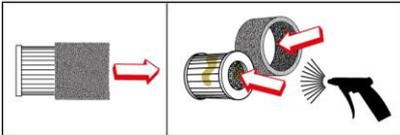
Para la limpieza, retire el prefiltro del filtro de admisión propiamente dicho y sople ambos filtros con aire comprimido.
